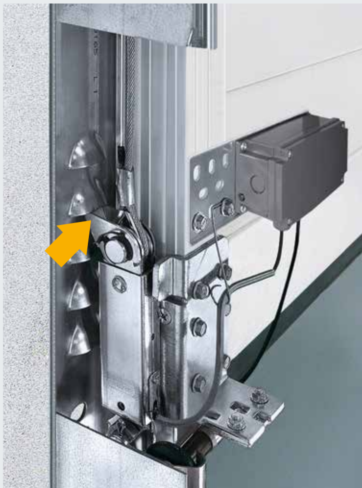
Il dente di bloccaggio della protezione antisollevamento scatta automaticamente in posizione nel caso di tentativi di sollevamento non autorizzato.
